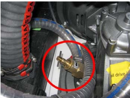
Wassereinlauf Motor: unmittelbar an der Halterung Zugang: BB-Kabine
