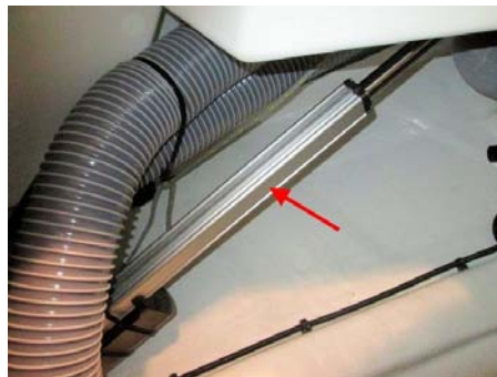
Elektrischer Zylinder Standort: Backskiste Cockpit
