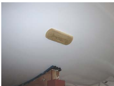
Kondensator (Platte aus Mikrokügelchen) Standort: Kleiderschrank - StB-seitige Achterkabine
