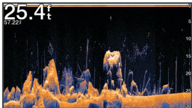
Los transductores tradicionales emiten un haz cónico. La tecnología de la sonda de exploración Garmin ClearVü emite dos haces estrechos similares a la forma del haz de una fotocopiadora. Estos haces ofrecen una imagen más clara, similar a una fotografía, de lo que hay debajo de la embarcación.
